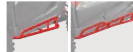
3.18 cm STEEL TUBE CONSTRUCTION FOR
